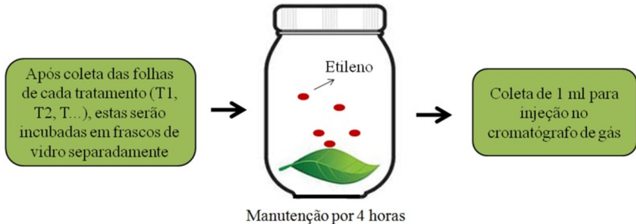
Figura 8. Esquema para quantificação de etileno em cromatografia de gás.
