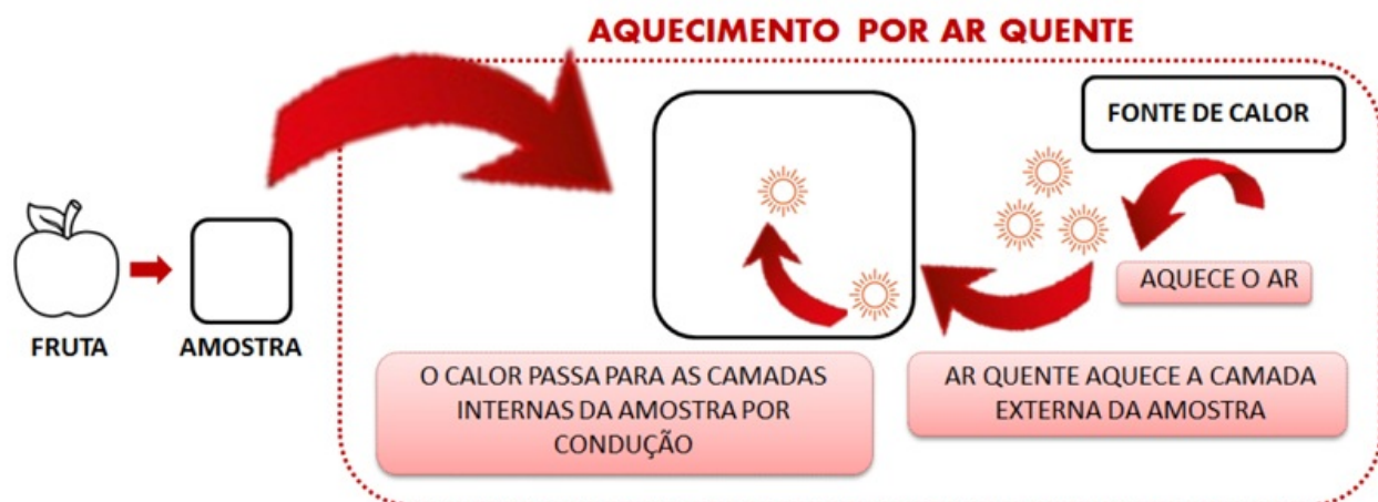
Figura 3 – Esquema do aquecimento por ar quente em estufa convectiva.
